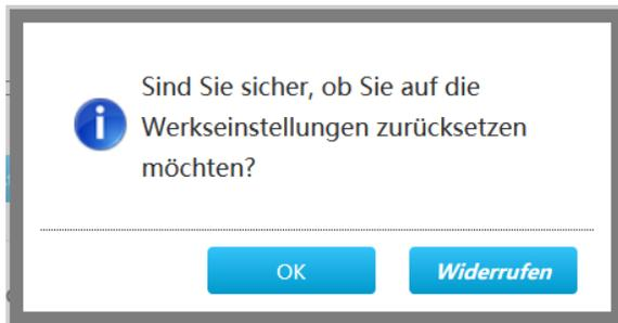
Drücken Sie auf **"Werkseinstellung wiederherstellen"**. Aus Sicherheitsgründen werden Sie erneut gefragt, ob Sie die Einstellungen wirklich zurücksetzen möchten. Bedenken Sie bitte, dass Einstellungen wie MAC-Filter, SSID, WLAN-Key etc. gelöscht werden. Wenn Sie sich sicher sind, drücken Sie auf OK.
